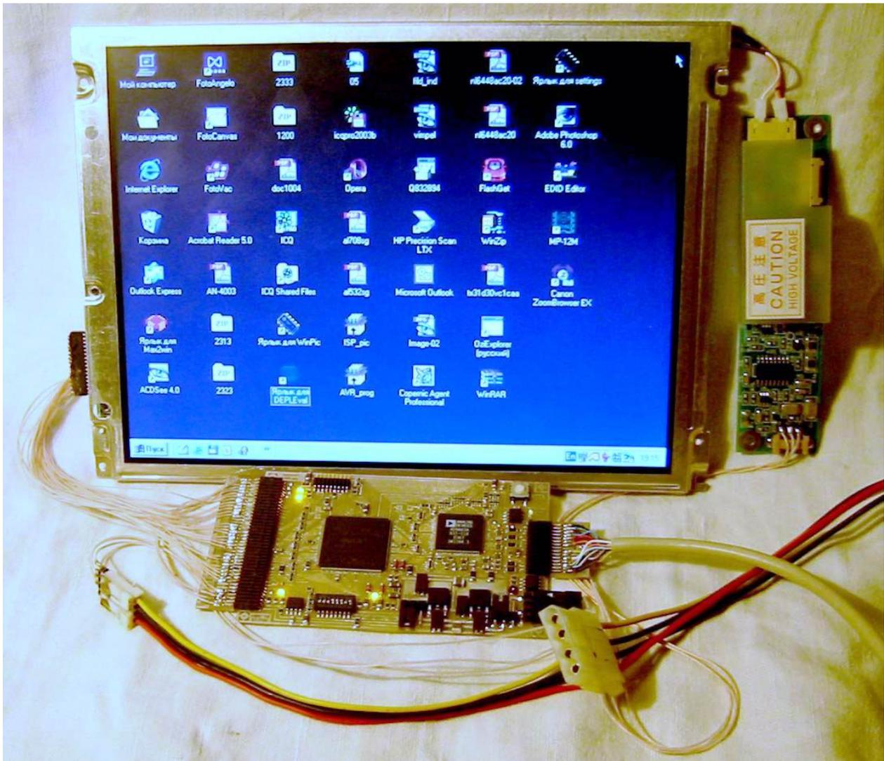
**Так как данное устройство является упрощенным контроллером ЖК-монитора, то мы гарантируем корректную его работу только со штатным (аппаратным разрешением подключаемой матрицы). В других (не штатных) режимах возможно отсутствие изображения или присутствие на изображении разных артефактов.**
